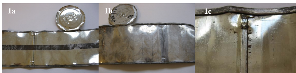
Figur 1a). Insidan på en uppklippt lackerad lödd burk, med det typiska olackerade bandet som ger en liten avsiktlig tennutlösning. 1b) Utsidan på samma burk 1c) Lödfog i närbild. Vid lödningen tränger det smälta blyet in i fogen och tätar den.
