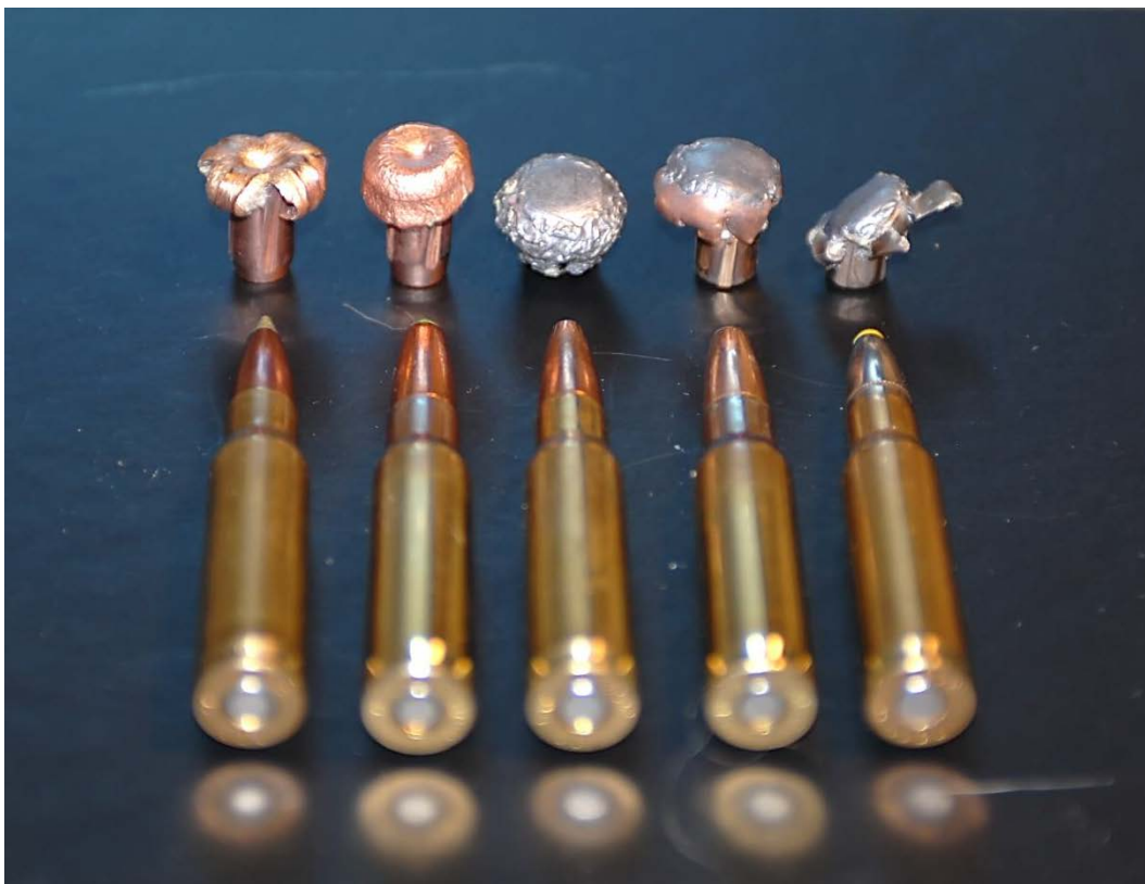
Figur 1. De olika kulor som användes i undersökningen, skjutna i kaliber .308 Win., in i plastback fylld med blötlagda telefonkataloger för att simulera träff i vilt. Från vänster Nosler E-tip (homogen kopparkula; restvikt 99,2 procent), Lapua Naturalis (homogen kopparkula; restvikt 99,6 procent), Norma Oryx (bondad kula med blykärna; restvikt 94,1 procent), Lapua Mega (obondad kula med blykärna; restvikt 89,0 procent) och Norma Silverblxt (obondad kula av äldre typ med blykärna; restvikt 60,7 procent).
