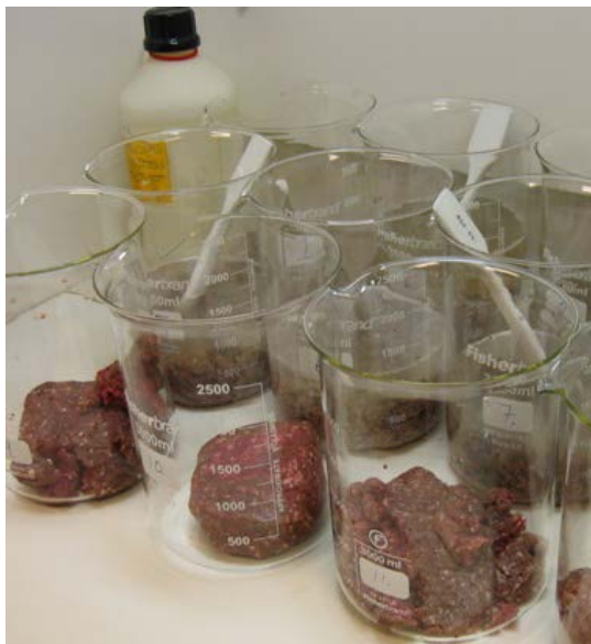
Figur 2. Provbereitung för extraktion/upplösning av metallpartiklar. Övre bilder från vänster: invägning i 3 liters bägare samt tillsats av 15 procent salpetersyra. Nedre bilder från vänster: älgfärs före och efter tillsats av salpetersyra.
