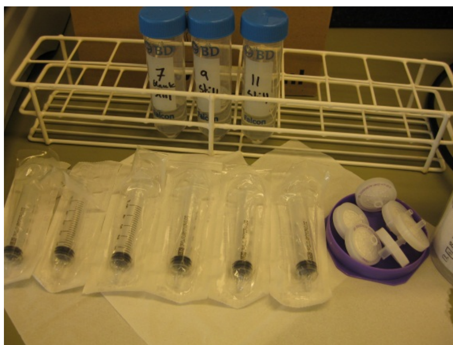
Figur 4. Blyspån, vardera 8 mg, placerades i 50 ml provrör med 40 ml 0,1 M saltsyra. Tre prov, en blank och två prov placerades på en skakmaskin och respektive i provrörstall.
