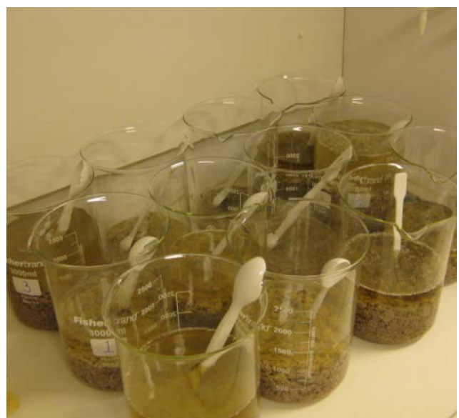
Figur 2. Provbereitung för extraktion/upplösning av metallpartiklar. Övre bilder från vänster: invägning i 3 liters bägare samt tillsats av 15 procent salpetersyra. Nedre bilder från vänster: älgfärs före och efter tillsats av salpetersyra.
