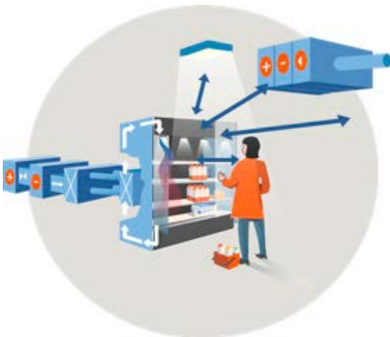
Figur 2. Energianvändningen i livsmedelslokaler påverkas av flera faktorer. Dels är det en växelverkan (infiltration) av varmt och kallt mellan kyldiskar, omgivande inneklimat och kunder och personal, men klimatstyrande installationer och belysning påverkar också livsmedelslokalernas interaktioner från komponent-system-byggnad.
