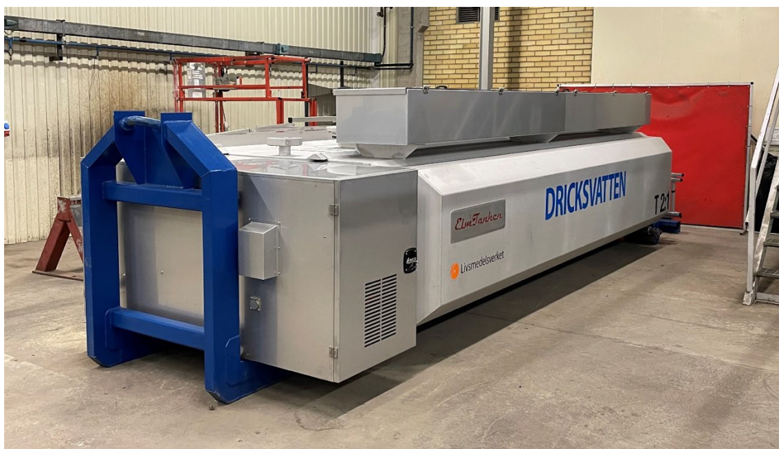
Figur 17. VAKA:s 10 m 3 nödvattentankar är byggda på lastväxlarflak och försedda med tryckstegringspump, elverk och internt rengöringssystem.
