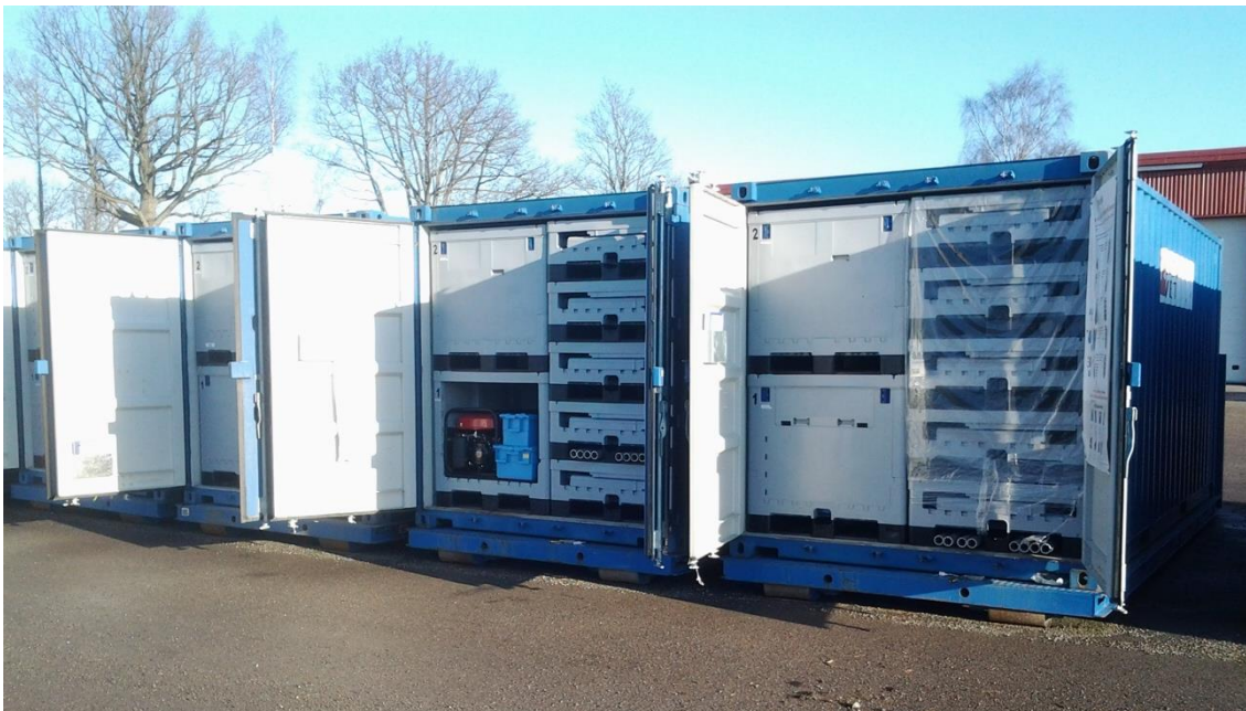
Figur 1. VAKA:s 1 m 3 nödvattentankar med tillhörande utrustning lagras i containrar byggda på lastväxlarflak.
