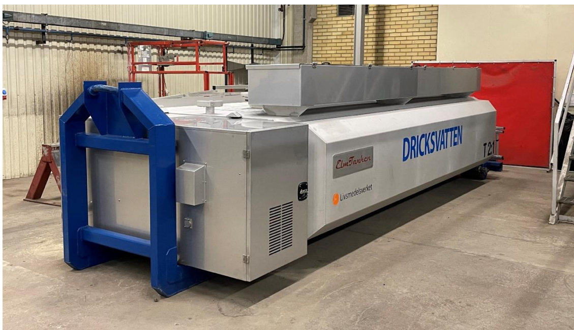
Figur 2. VAKA:s 10 m 3 nödvattentankar är byggda på lastväxlarflak och försedda med tryckstegringspump, elverk och internt rengöringsystem.
