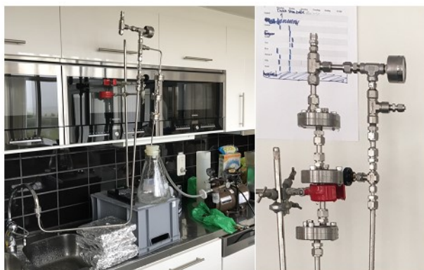
Figur 1. Provtagningsuppställning för filter på 10-1-0,4 \mu\text{m} till vänster i bilden och för filter på 100-30-10 \mu\text{m} till höger.
